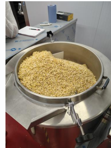
Asciugatura fave di soia su brasiera ingegnerizzata per raffreddamento
