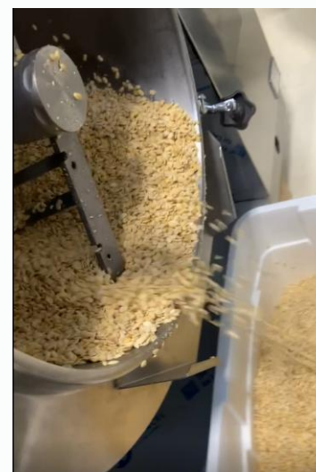
Fine del trattamento dopo un totale di 20 minuti con raggiungimento della temperatura obiettivo e scarico prodotto
