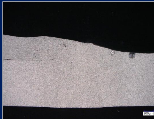
32 lamine di Al da 20 \mu m su una linguetta da 600 \mu m di Al
