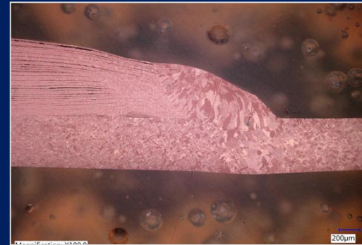
40 lamine di Cu da 8µm su una linguetta di rame da 600µm (600W)
