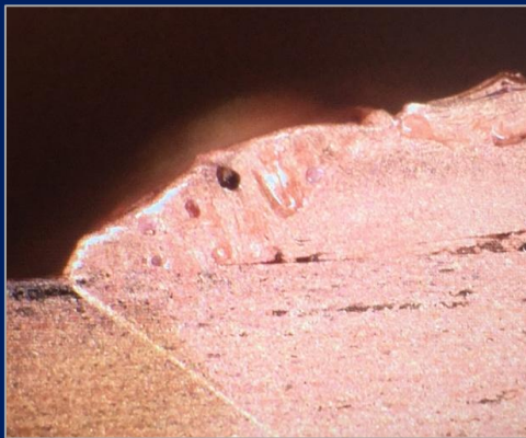
40 lamine di Cu da 8 \mu m su una linguetta di rame da 600 \mu m
